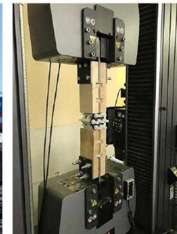
Рис. 13. Образец в захватах разрывной машины Instron 5998. Фото Д. А. Животова, 2020 г.
