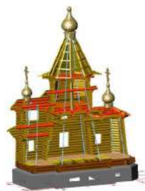
Рис. 11. Вертикальный 3D-разрез с расположением цепных тяг со стяжными муфтами, притягивающих остов храма к фундаменту
