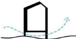
Сохранение вечной мерзлоты путем создания вентилируемого подполья
