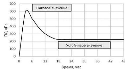
Рис. 14. Принципиальная зависимость формирования касательных сил морозного пучения, предложенная Б. И. Далматовым
